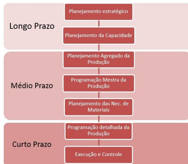
Figura 1 - Níveis hierárquicos da estratégia de produção, funções de PCP x horizonte de tempo Fonte: Adaptado de Lustosa, et al, 2008
