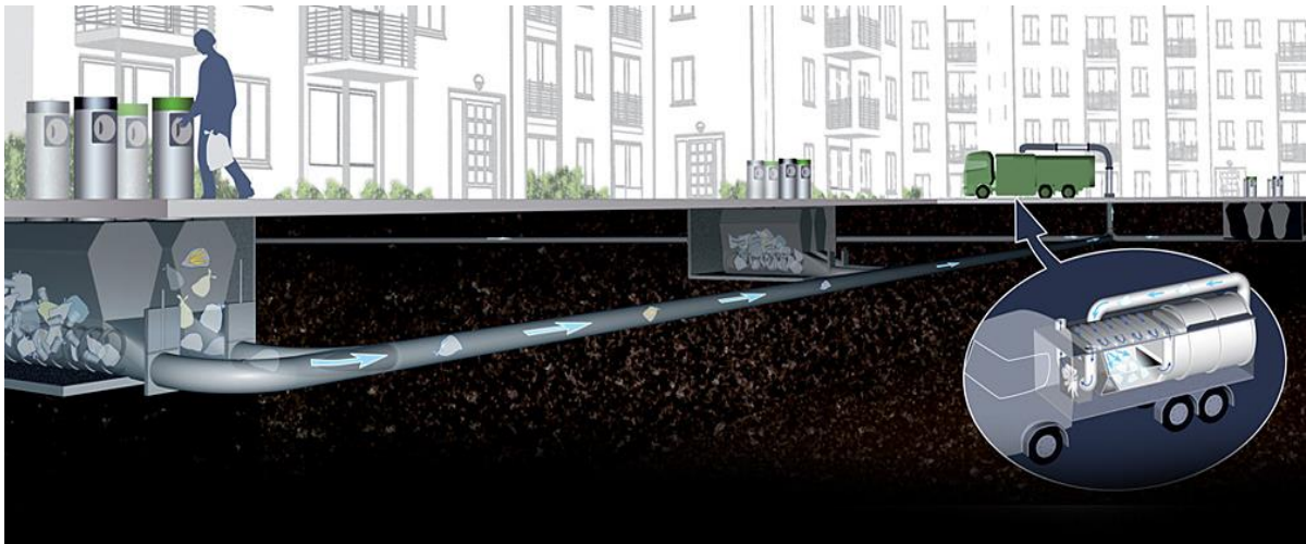
Figura 7 - Sistema de armazenamento subterrâneo e coleta por caminhões.
