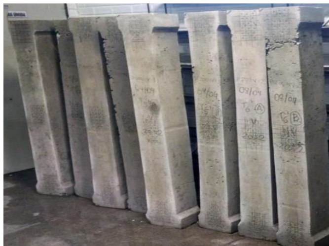
Figura 4: Pilares moldados em laboratório
