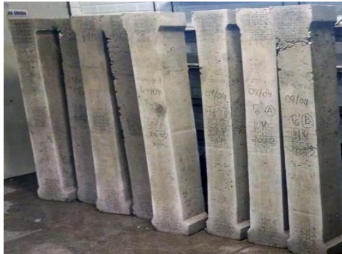
Figura 4: Pilares moldados em laboratório
