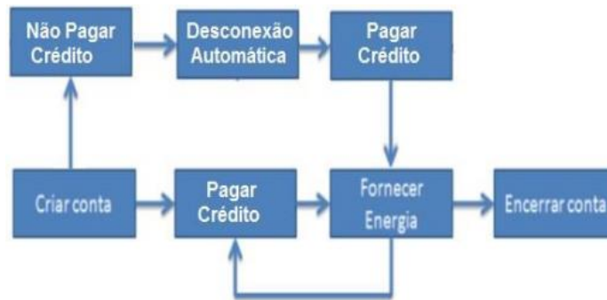
Figura 4 - Fluxograma da tarificação pelo sistema pré-pago.
