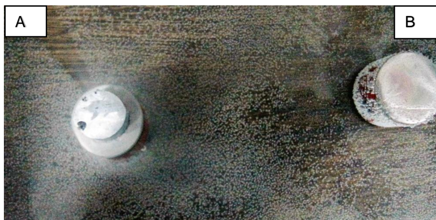
Figura 5 – Coloração da água envolvendo o aço inoxidável AISI 304 após 96 horas de submersão
