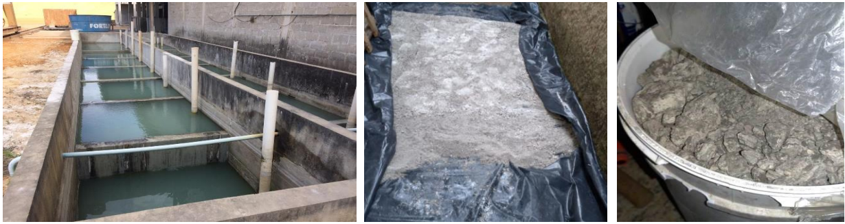
Figura 1: (a) Tanque de armazenamento do resíduo; (b) Lama exposta ao sol por 7 dias para secagem (c) “torrões” originados pela secagem. Fonte: Autor (2019).
