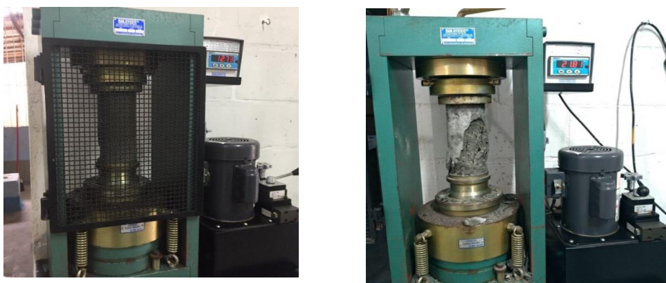
Figura 6: (a) Equipamento para ensaio de compressão axial com grade de proteção; (b) sem a grade de proteção para melhor análise do material rompido.
