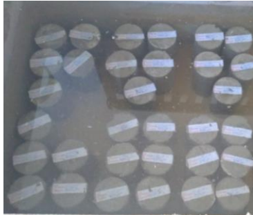
Figura 4: (a) Moldagem dos corpos de prova de concreto (Tipo A e B); (b) Moldagem dos corpos de prova – ensaio pozolânico – de argamassa; (c) Corpos de prova retirados dos moldes com um dia e submergidos em água com cal para cura de 7 e 28 dias; (d) Moldes retirados da cura para realização do ensaio de compressão.
