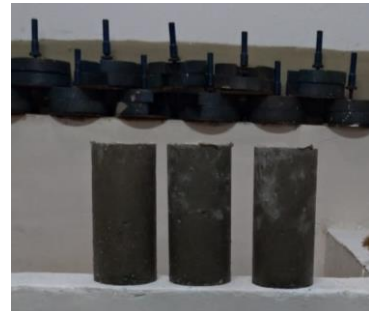
Figura 4: (a) Moldagem dos corpos de prova de concreto (Tipo A e B); (b) Moldagem dos corpos de prova – ensaio pozolânico – de argamassa; (c) Corpos de prova retirados dos moldes com um dia e submergidos em água com cal para cura de 7 e 28 dias; (d) Moldes retirados da cura para realização do ensaio de compressão.
