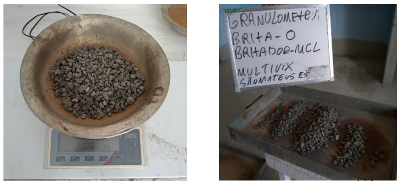
Figura 2: (a) pesagem do agregado graúdo (brita 0) antes do ensaio granulométrico; (b) representação crescente da dimensão dos agregados graúdos. Fonte: Autor (2019)
