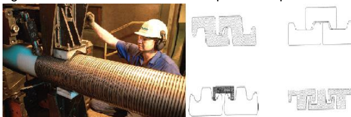
Figura 9: Processo de armadura de pressão e perfis metálicos.
