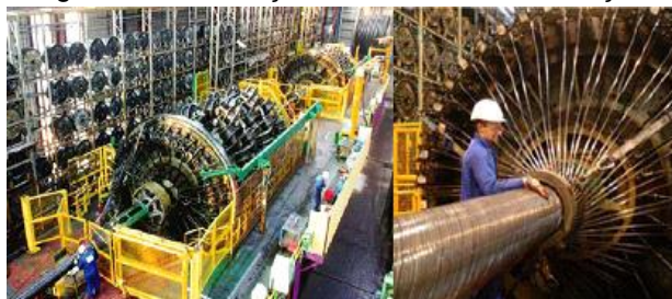
Figura 11: Fabricação das armaduras de tração.
