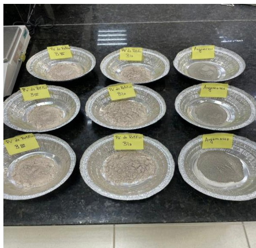
Figura 3 – Amostras para ensaio de determinação de umidade.
