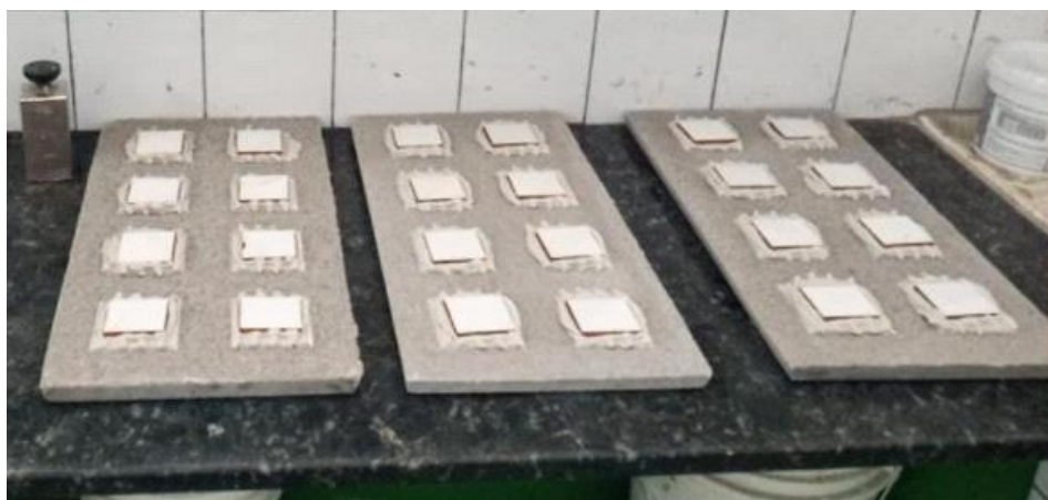
Figura 4 – Placa de concreto com os corpos de prova.
