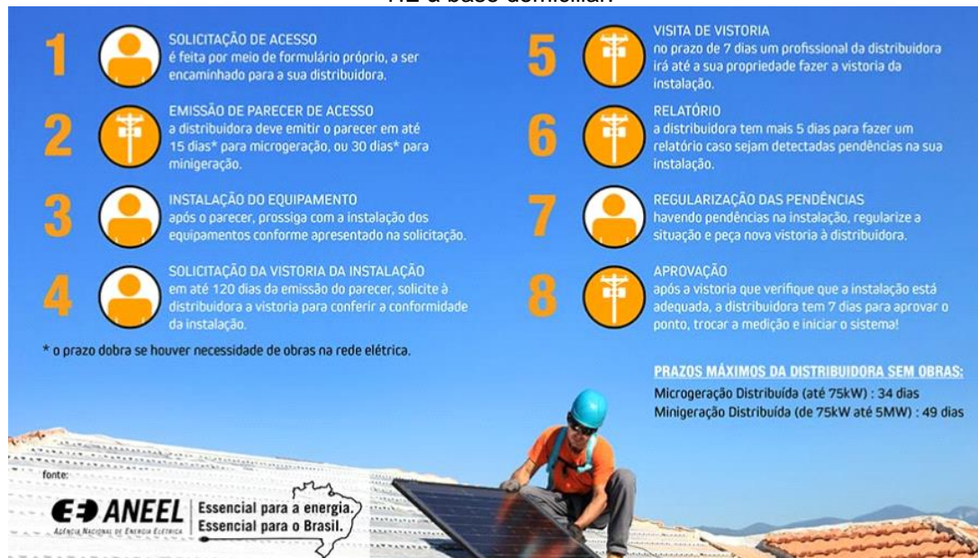
Figura 2 – Passo-a-passo junto à concessionária de energia a instalar/conectar o SFVCR/Grid-TIE à base domiciliar.
