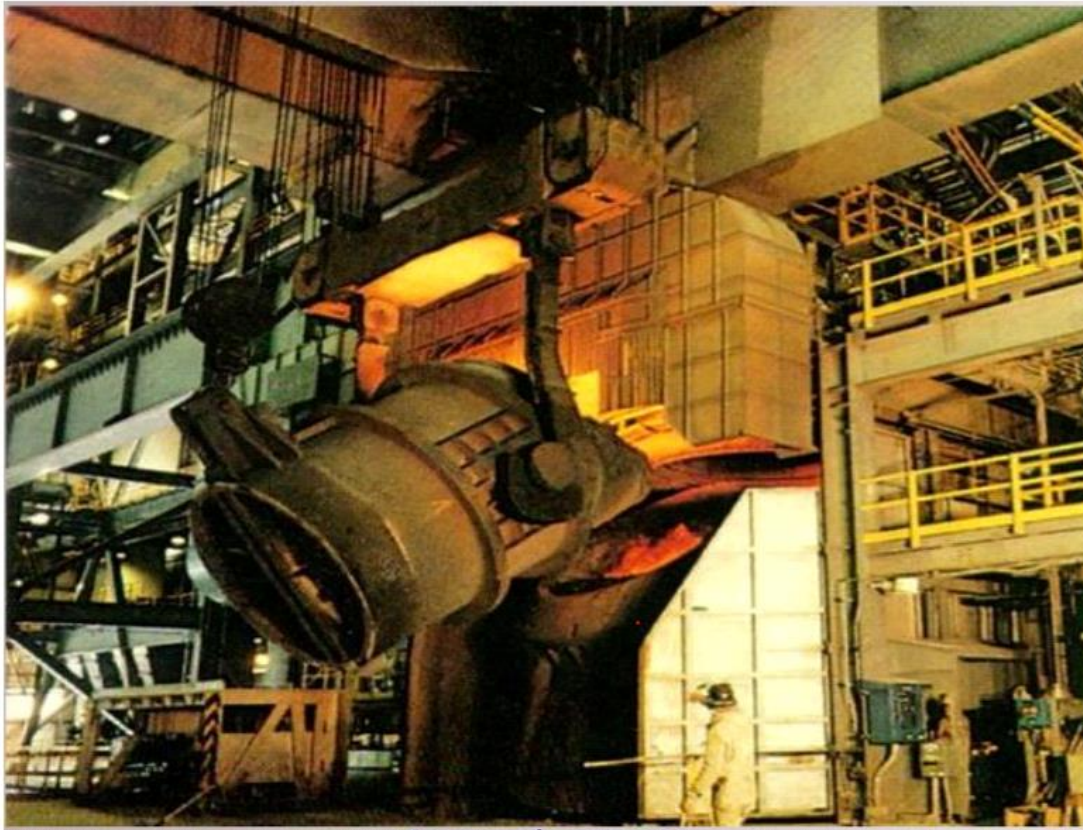
Figura 2. Carregamento de conversor LD com uma ponte rolante de panela
