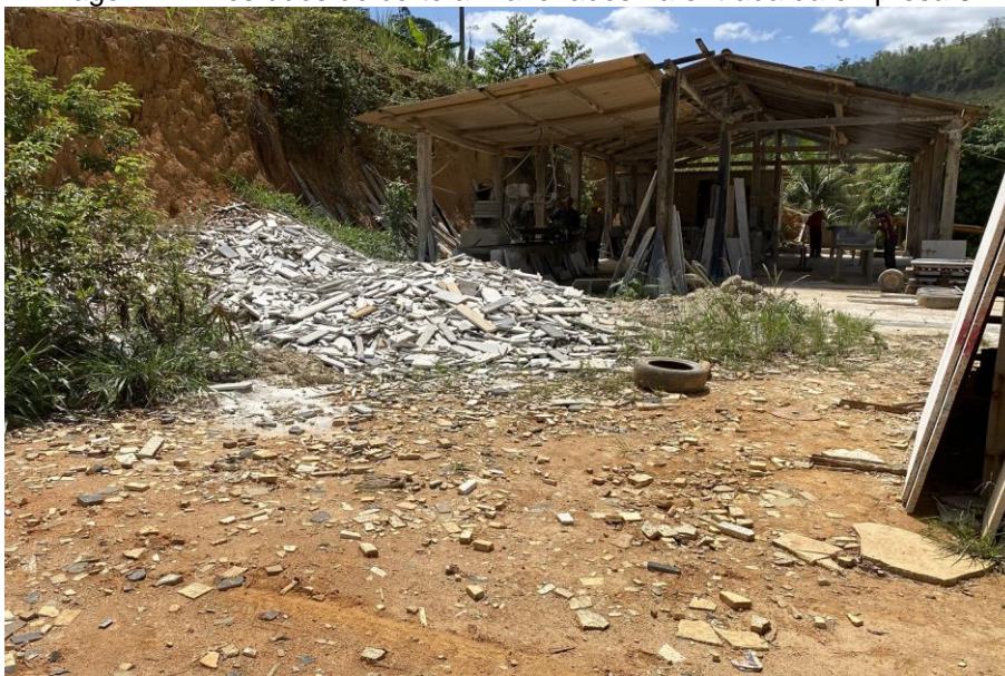
Imagem 1 – Resíduos de corte armazenados na entrada da empresa 3.
