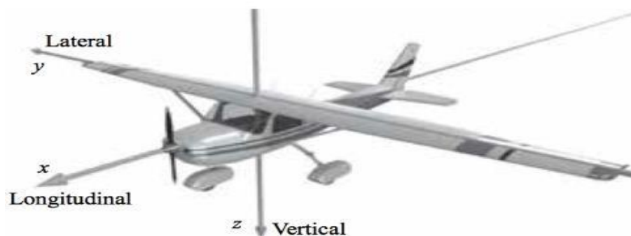
Imagem 2 – Eixos de coordenadas de uma aeronave.
